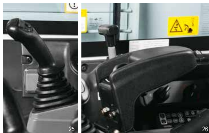
ERGONOMISCH ANGEORDNETE JOYSTICKS UND HÖHENVERSTELLBARE ARMLEHNEN MIT INTEGRIERTER DREHZAHLEINSTELLUNG
