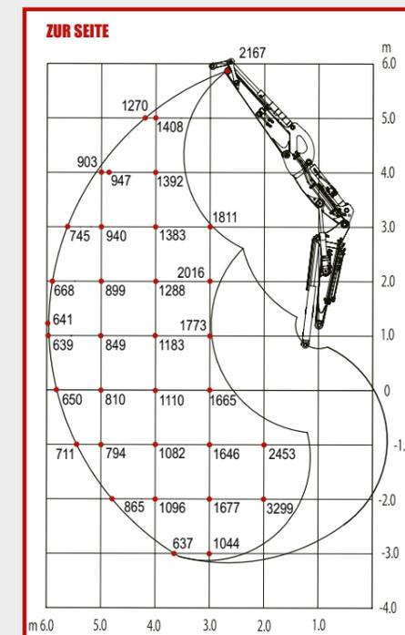
Die Hublasten in den Grafiken betragen bis zu 87 % der hydraulischen Hublast bzw. bis zu 75 % der Kipplast. Die Werte sind in Kilogramm angegeben – ohne Powertilt. Technische Änderungen vorbehalten.
